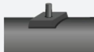
En la zona de apoyo se debe colocar un protector aislante (TF401) compuesto por un disco aislante 53 mm. de diámetro ubicándolo como se indica. Centrando el aislante para que cubra la totalidad del disco metálico.
